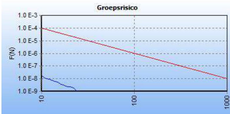
5.4 Figuur 5.4 FN curve voor 7398_leiding-N-570-32-deel-1 van N.V. Nederlandse Gasunie voor de kilometer tussen stationing 0.00 en stationing 0.00
